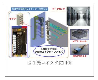
クタは、数 µm 単位で光ファイバの位置が制御されているかつ、安定してサーバー機器との通信が行えることが要求されるため、非常に高度な加工技術が要求されます。これを可能にするのが世界の光通信技術を支えてきたフジクラです。フジクラの光コネクタは世界各国で使用され、特に大容量通信を可能にする MT コネクタでは世界トップシェアを誇っています。
